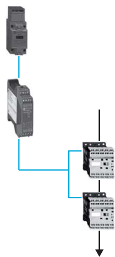
包装机械安全部分的控制电路框图
